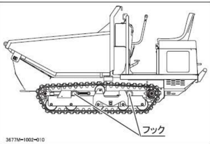
1. フレームの前後左右についている吊り上げ用フック（4ヶ所）にワイヤーロープを掛け、機体の中央（左右方向）で吊り上げてください。
